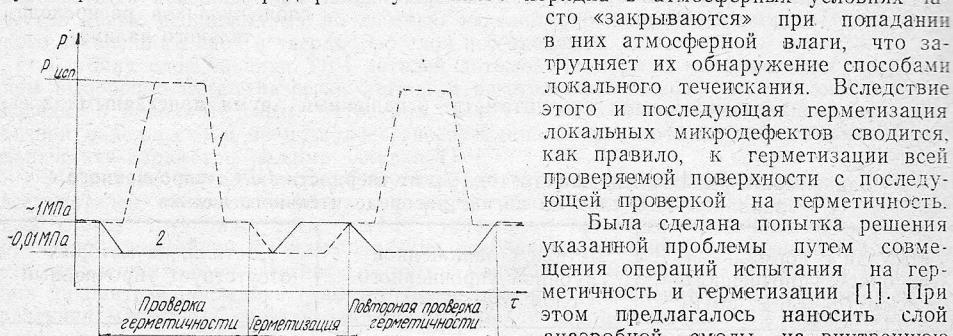
Рис. 1. Циклографика изменения давления в процессе испытаний:
