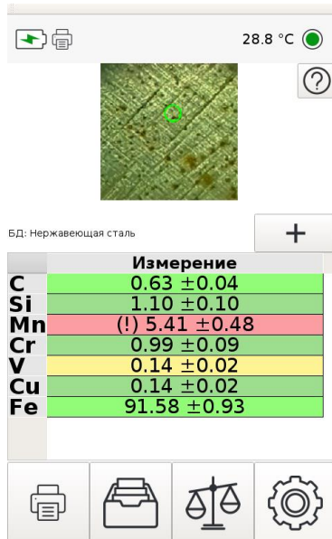
Рисунок 7 Ошибка измерения марганца в нержавеющей стали
