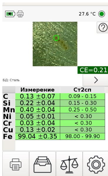
Рисунок 24 Измерение стали с отображением углеродного эквивалента
