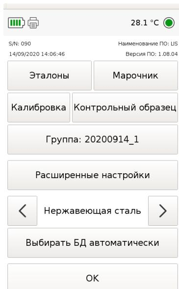
Рисунок 11 Окно настроек спектрометра
