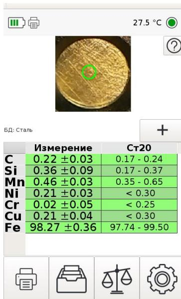
Рисунок 2 Главное окно ПО спектрометра
