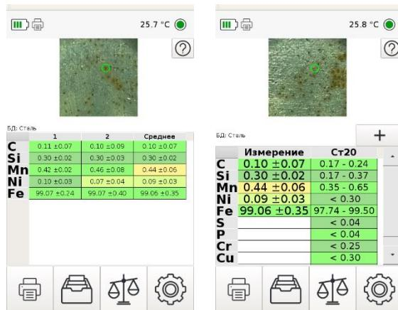
Рисунок 17 Измерение с функцией усреднения нескольких серий.
