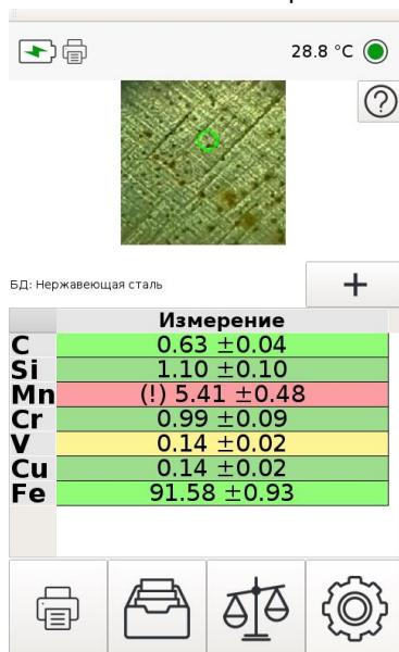
Рисунок 7 Ошибка измерения марганца в нержавеющей стали
