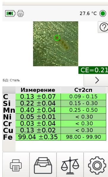
Рисунок 24 Измерение стали с отображением углеродного эквивалента
