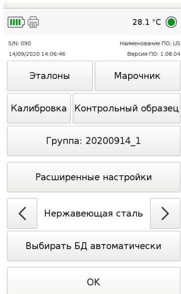
Рисунок 14 Окно настроек спектрометра
