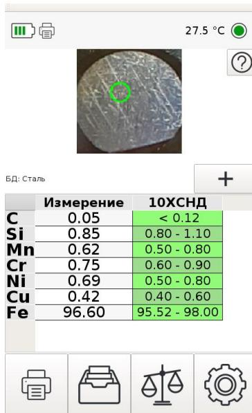
Рисунок 6 Результаты измерения стали марки 10ХСНД
