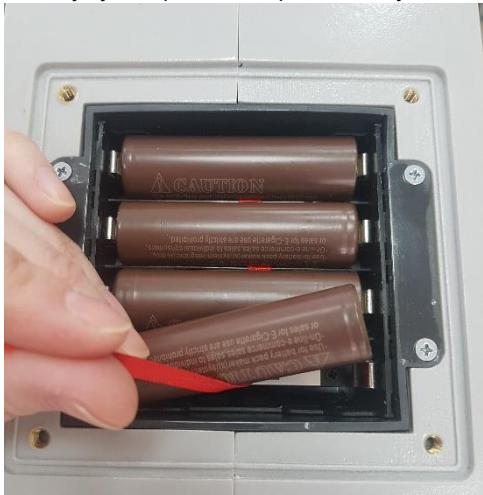
5. Вставьте другой комплект аккумуляторных батарей (**Внимание!** Ленту размещайте под аккумуляторами для простоты извлечения их из батарейного отсека).
