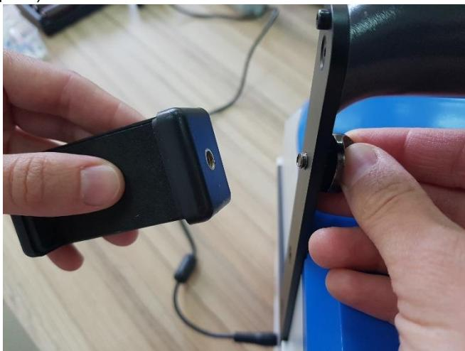
4. Закрутите винт в резьбу на держателе.
