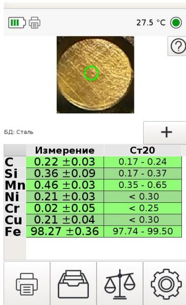
Рисунок 4 Главное окно ПО спектрометра
