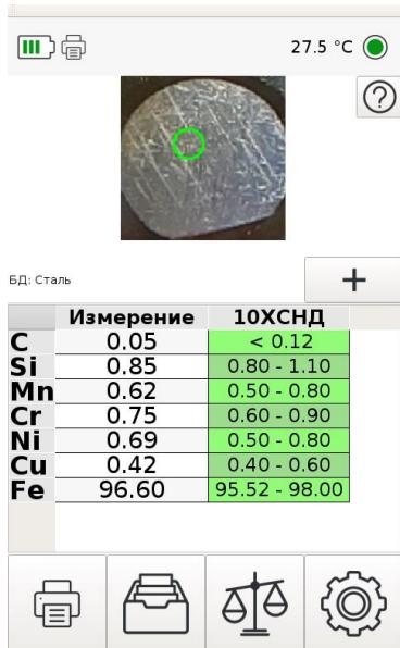
*Рисунок 4 Результаты измерения стали марки 10ХЧНД*
