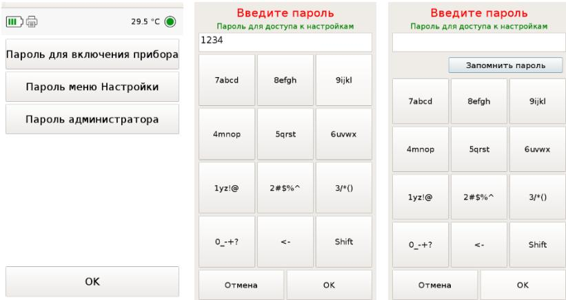
Рисунок 19 Окно меню Безопасность, настройка и проверка пароля для доступа
