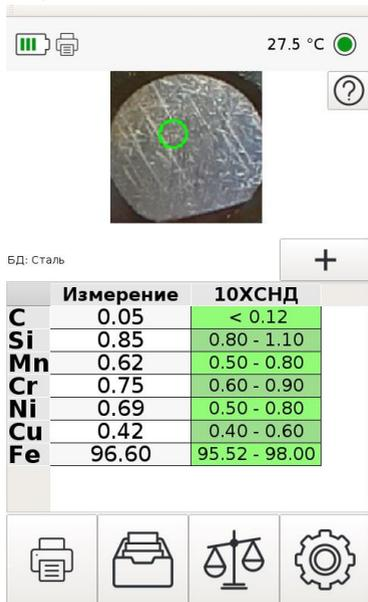
*Рисунок 5 Результаты измерения стали марки 10ХСНД*
