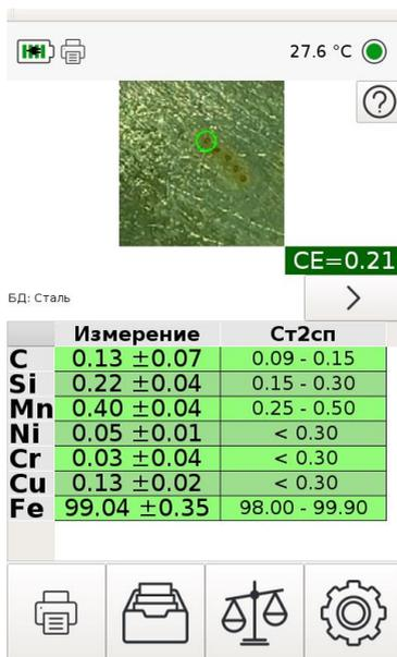
Рисунок 23 Измерение стали с отображением углеродного эквивалента
