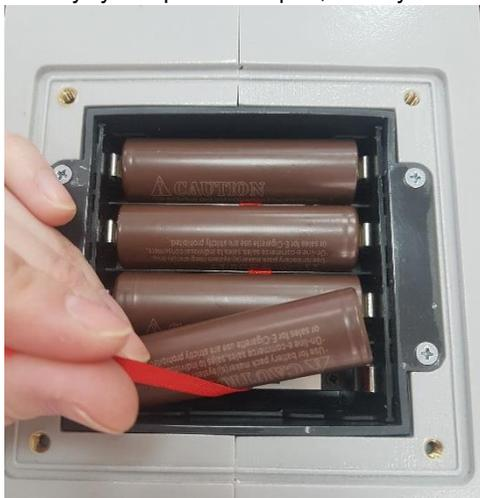
5. Вставьте другой комплект аккумуляторных батарей (**Внимание!** Ленту размещайте под аккумуляторами для простоты извлечения их из батарейного отсека).
