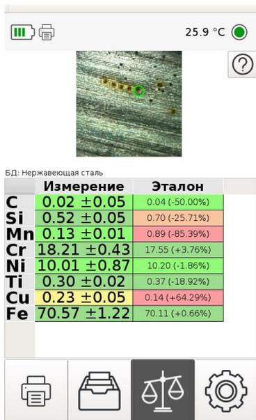
Рисунок 9 Окно измерений в режиме сравнения с измерением образца
