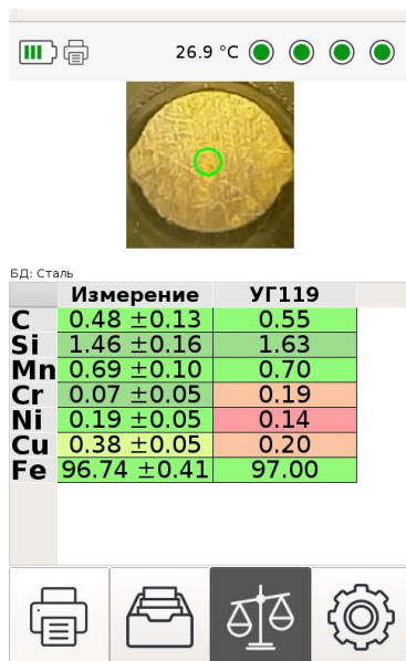
Рисунок 4. Окно измерений в режиме сравнения
