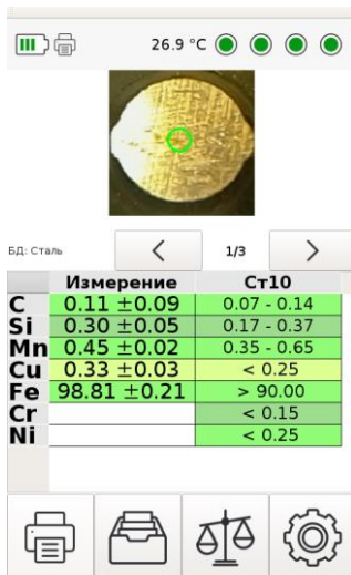
Рисунок 2. Главное окно ПО спектрометра
