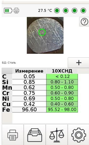
*Рисунок 4 Результаты измерения стали марки 10ХЧНД*
