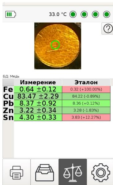
Рисунок 7 Окно измерений в режиме сравнения с эталоном
