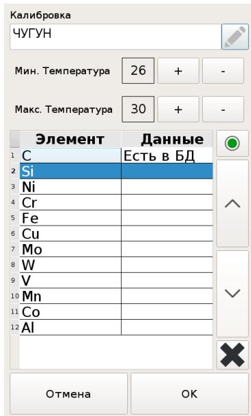
Рисунок 22 Изменение параметров калибровки
