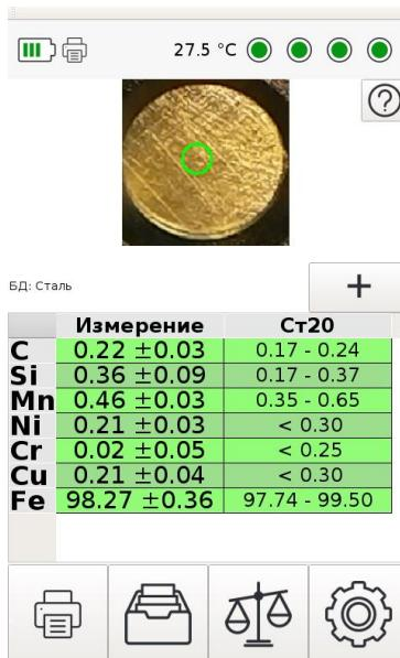
Рисунок 2 Главное окно ПО спектрометра
