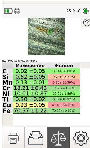
Рисунок 8 Окно измерений в режиме сравнения с измерением образца
