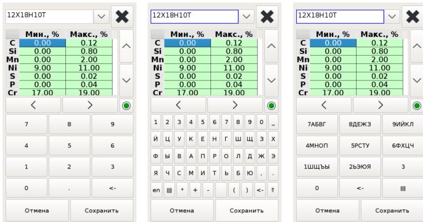
Рисунок 29 Редактирование материала выбранного марочника
