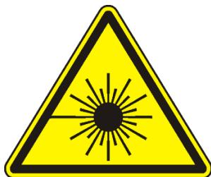
**Внимание!** Спектрометр содержит источник лазерного излучения, класса 3b. Не допускается наведение выходного отверстия прибора на человека или животных. Персонал должен быть проинформирован об опасности поражения лазерным излучением и мерах защиты органов зрения от лазерного излучения ИК спектра.
